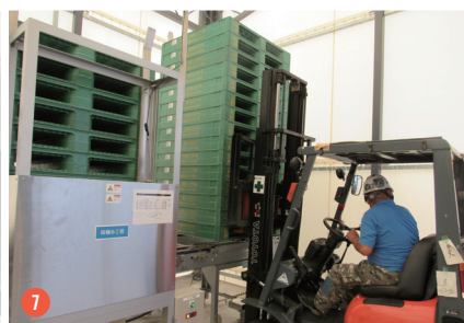
7 洗浄済みパレットをフォークリフトで下ろす
