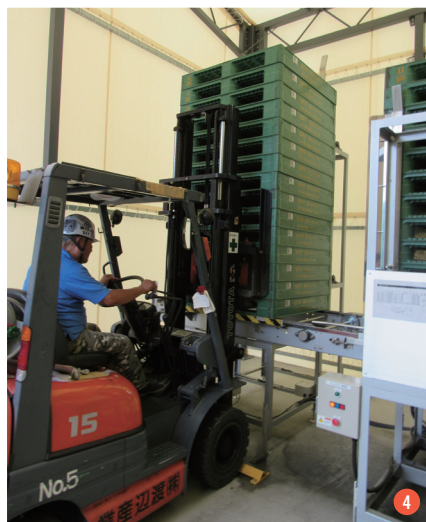
4 フォークリフトでパレットを装置に投入
