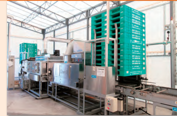
本事業によって導入したパレット洗浄ライン
